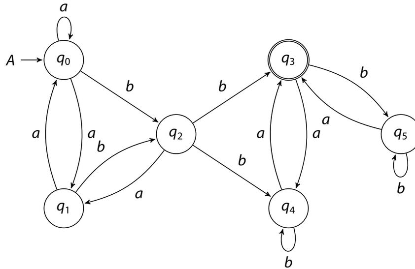
Determinisieren Sie  $A$ , bestimmen Sie also einen DFA  $B$  mit  $\mathcal{L}(A) = \mathcal{L}(B)$  unter Verwendung der Rabin-Scott-Potenzmengenkonstruktion.
